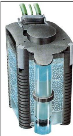
A tecnologia Sêco/húmido permite a entrada de oxigénio no filtro de uma forma regular, permitindo que as matérias filtrantes e as bactérias desnitrificantes entrem em contacto com um maior nível de oxigénio. Como resultado, as bactérias actuam de uma forma mais efectiva e intensa, decompondo a matéria orgânica mais rápida e consistentemente. Depois de filtrada a água retorna com um nível de oxigenação muito superior ao aquário
